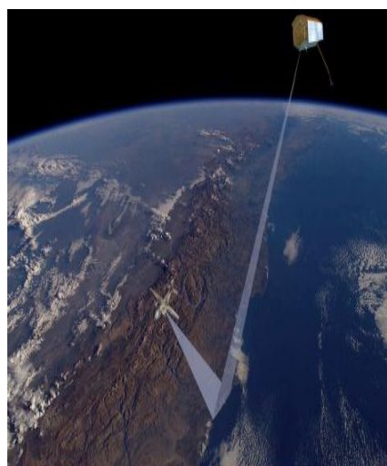
Рис.4. Построение авиационно-космического бистатического эксперимента (TerraSAR и Ramir, 2008 г)
