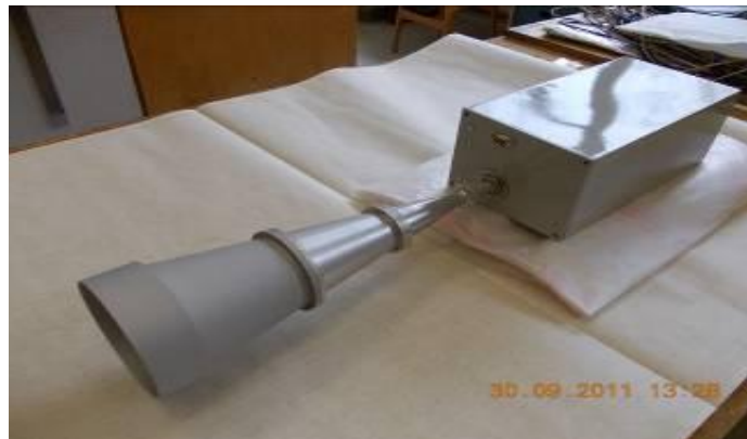
Рис.5. СВЧ радиометр для измерения общего содержания водяного пара
