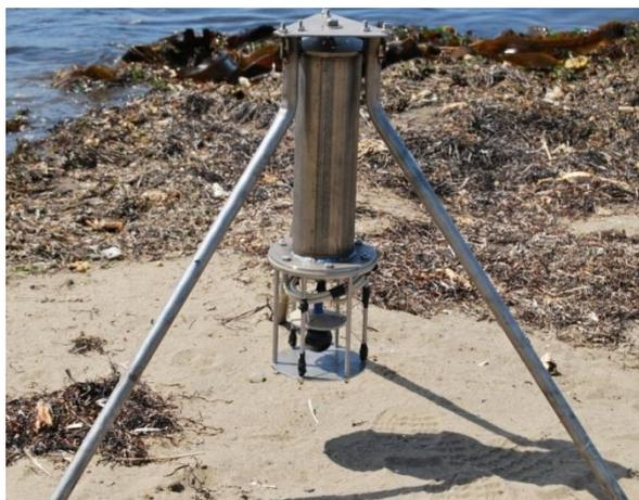
**Рис.1. Внешний вид гидрофонной автономной сейсмостанции (ГАСС).**
