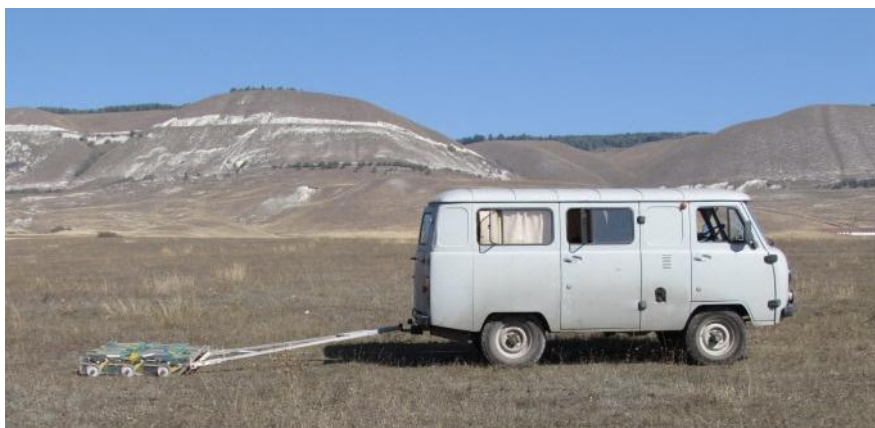
Рис.2. Процесс обследования археологической площадки георадаром МАРС300/4.
