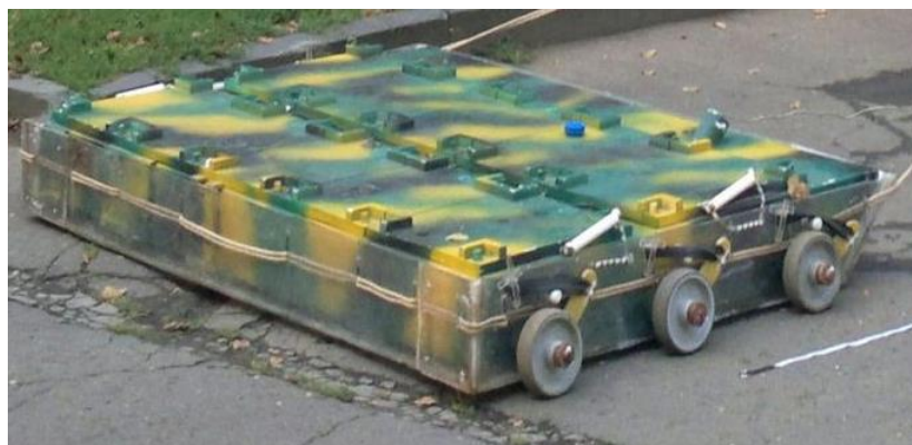
Рис.1. Внешний вид георадара МАРС-300/4
