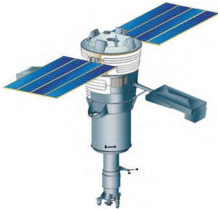
Рис. 3. КА Янтарь-4К1 разработки ЦСКБ-Прогресс с оптико-электронной цифровой фотокамерой Сплав и системой ретрансляции цифровой информации Сплав-1 разработки НПО ЭЛАС через спутник-ретранслятор «Поток» [7], Рис. 4. (Фото с сайта: https://ru.wikipedia.org/wiki/Янтарь-4К1 )
