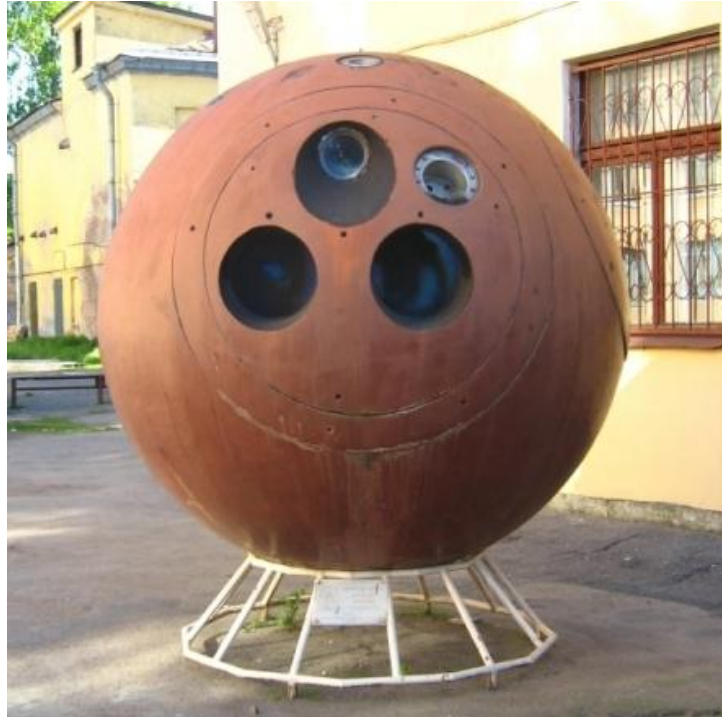
Рис. 1. Космический аппарат Зенит, созданный на базе пилотируемого КА Восток для целей космического фотографирования (Фото с сайта: Зенит (космический аппарат) — Википедия[1]).
