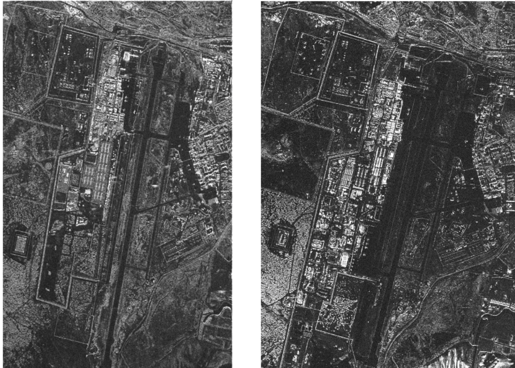
Рис. 13. РЛИ фрагмента аэродрома Джибути, Сомали. КА «TerraSAR-X», X-диапазон, 2008-08-19, HH, SL, 54,3 deg. КА «Кондор-Э», S-диапазон, 04.02.2015, VV, ДПР, 40,6 градусов
