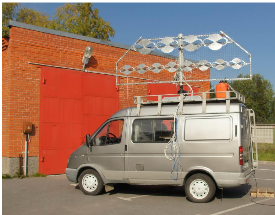
Рис. 14. Мобильная экспериментальная лаборатория СКИ РЛС
