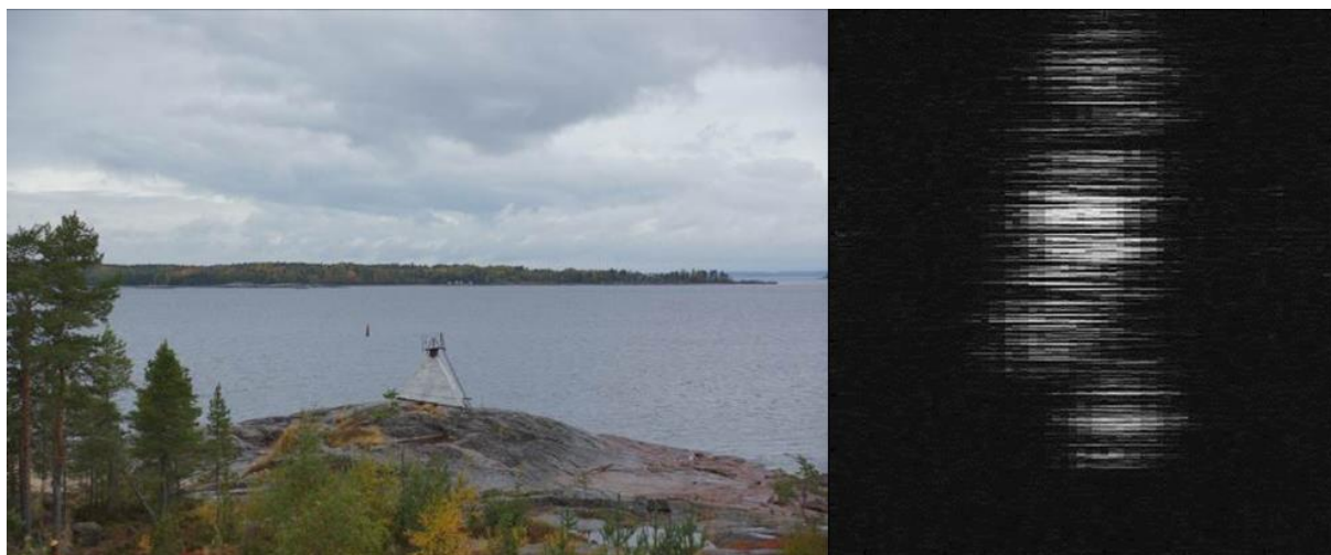
Рис.18. Радиолокационное изображение местности СКИ РЛС: острова. (масштаб развертки радиолокационного изображения 600 м)
