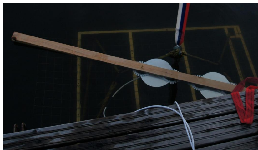
Рис. 20. Антенны СКИ РЛС и отражатель в воде
