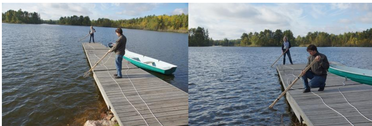
Рис. 22. Определение задержки времени прихода электромагнитного импульса
