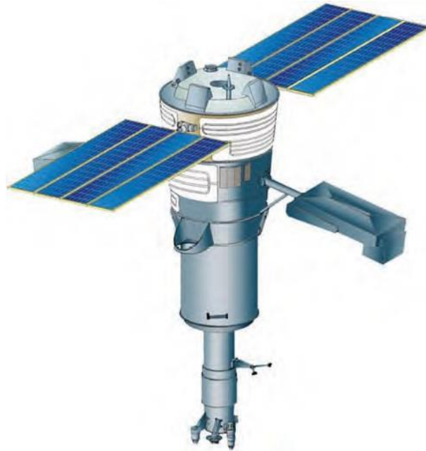
Рис. 7. КА Янтарь-4К1 разработки ЦСКБ-Прогресс с оптико-электронной цифровой фотокамерой Сплав и системой ретрансляции цифровой информации Сплав-1 разработки НПО ЭЛАС через спутник-ретранслятор "Поток" [17], Рис. 8. (Фото с сайта: https://ru.wikipedia.org/wiki/Янтарь-4К1 )
