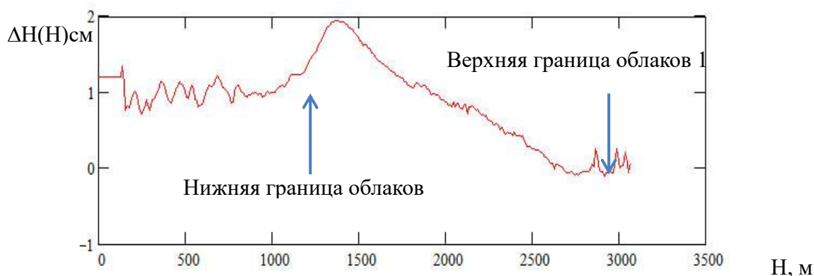
Рис. 4. Увеличение длины пути сигнал при прохождении сквозь облака.
