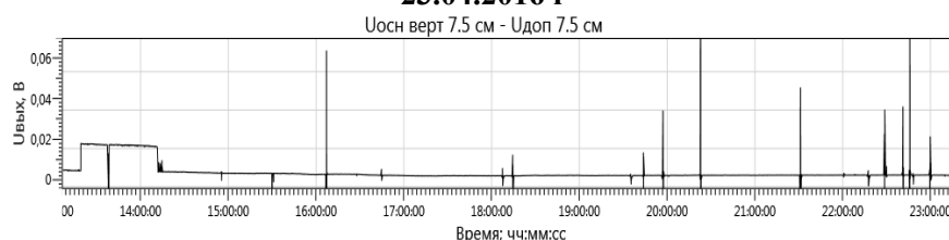
Рис. 6. Временные зависимости выходного разностного сигнала СВЧ радиометрической системы в диапазоне 7,5 см, характеризующего уровень радиотеплового излучения облачной атмосферы в условиях выпадения умеренных жидких осадков 23.04.2016 г. при выполнении компенсации влияния фоновых шумов
