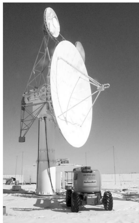
Рис. 1. Система многоволнового зондирования NOAA. Видны две параболические антенны диапазона 3 см сверху основной антенны радиолокатора CP-2.
