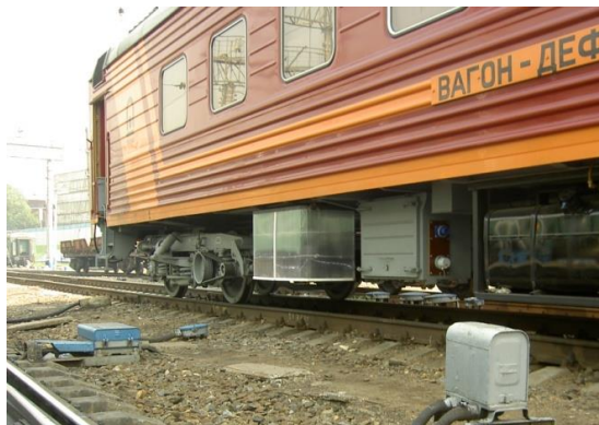
Рис.7. Двухдиапазонный георадарный измерительный комплекс для мониторинга состояния железнодорожного пути.
