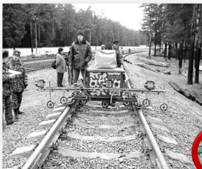
Рис.8. Радио-акустический комплекс для обнаружения мин на железной дороге.
