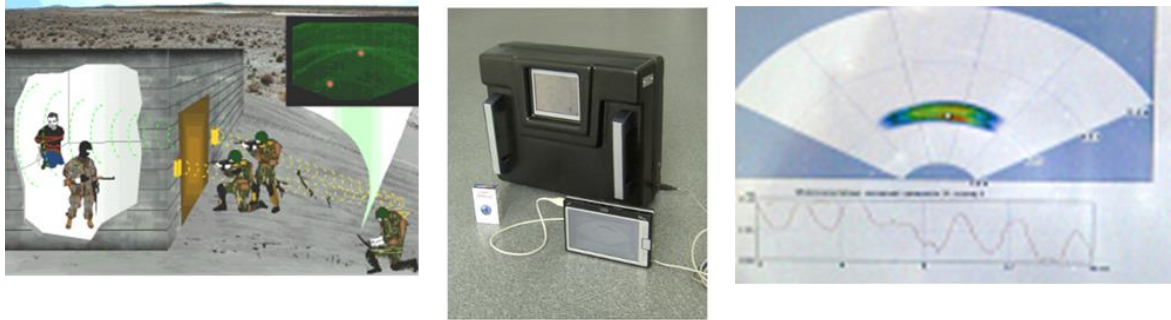
Рис.9. Радар "Герад-5" для обнаружения людей за стенами.
