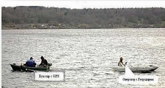
Рис. 6. Обследование структуры дна реки Свирь для прокладки газопровода.
