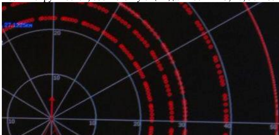
Рис. 2. Окно индикации наблюдаемой внешней обстановки в координатах азимут-дальность (фрагмент).
