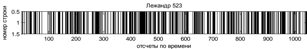
Рис. 8 Модель зондирующего сигнала с ФКМ последовательностью Лежандра длиной 523.
