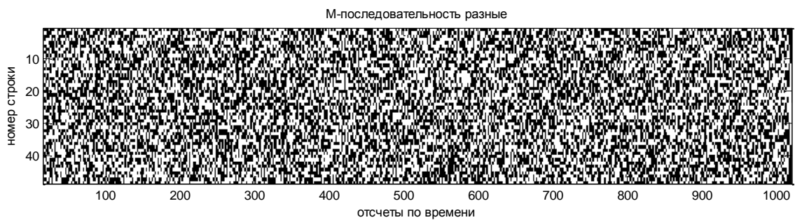
Рис. 5. Модель зондирующего сигнала с ФКМ различными М-последовательностями длины 511.
