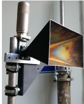
Рис.2. Приемная рупорная антенна с согласованием.
