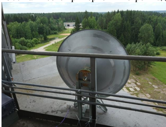
Рис.1. Передающая зеркальная антенна на поворотной платформе ТНА-1500.
