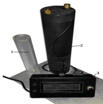
Рис. 2. Общий вид многоволнового измерителя прозрачности воды: 1 – измерительная кювета; 2- блок для кюветы с излучателями и приемником; 3 – индикаторное устройство.
