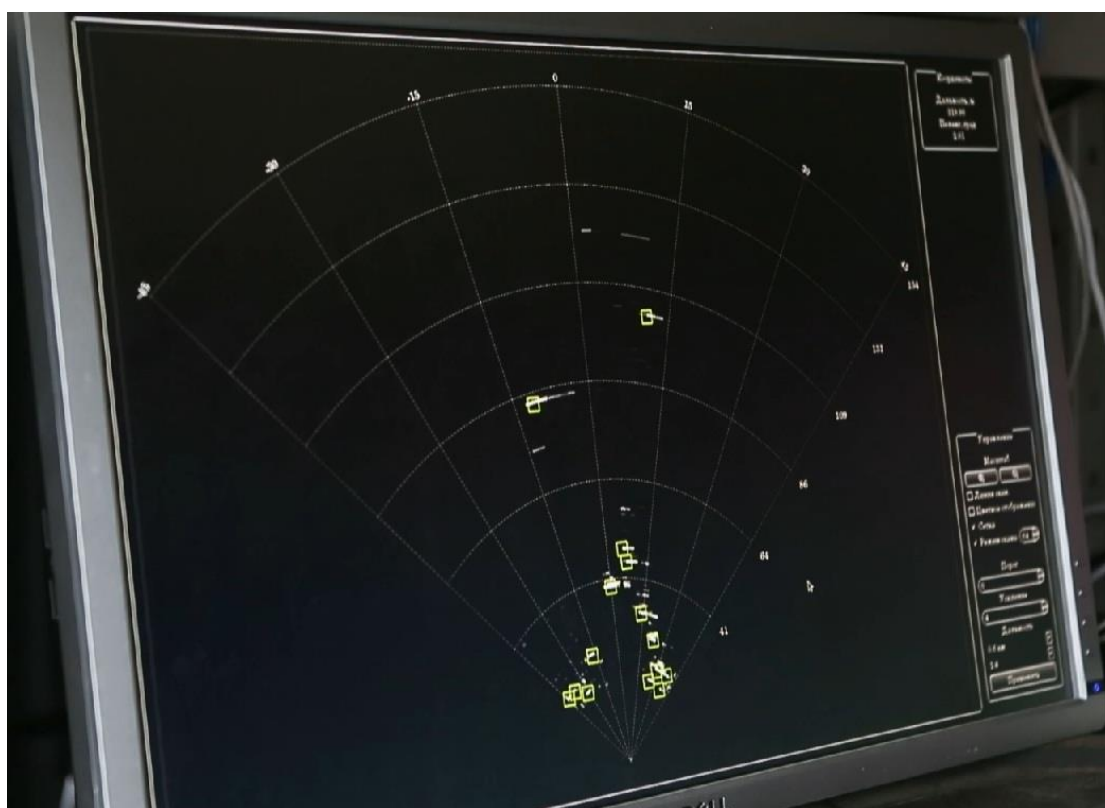
Рис. 2. Вид экрана устройства обработки автомобильной СКИ РЛС.
