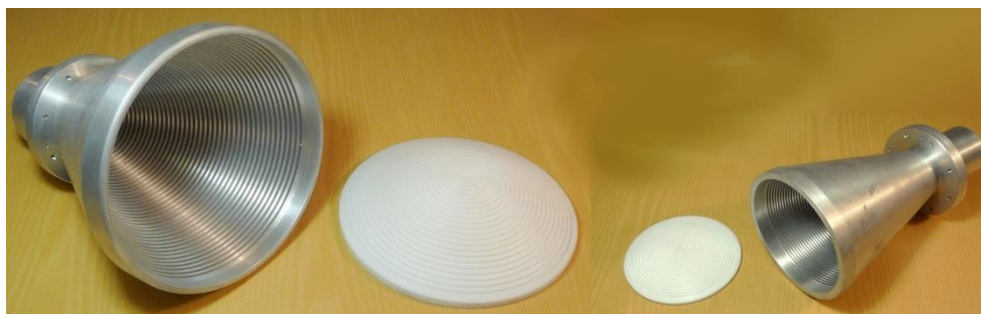
Рис. 2. Самолётные антенны СВЧ-влажмера для ЯК-42
