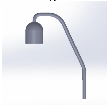
Рис. 3. Вариант конструкции крепления ПНП на мачту
