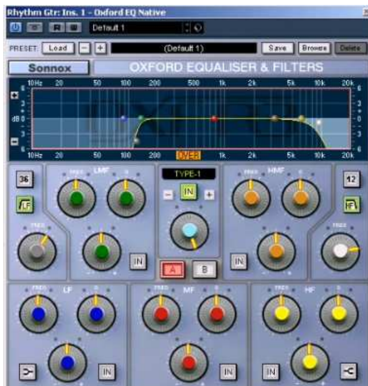
Рис.2. Срез низкочастотной составляющей и высокочастотной составляющей гитар
