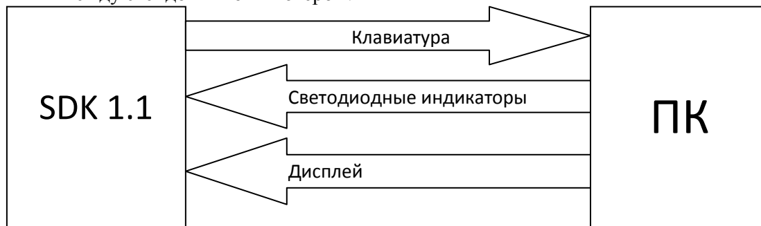
Рис.1. Потоки команд между SDK1.1 и ПК
