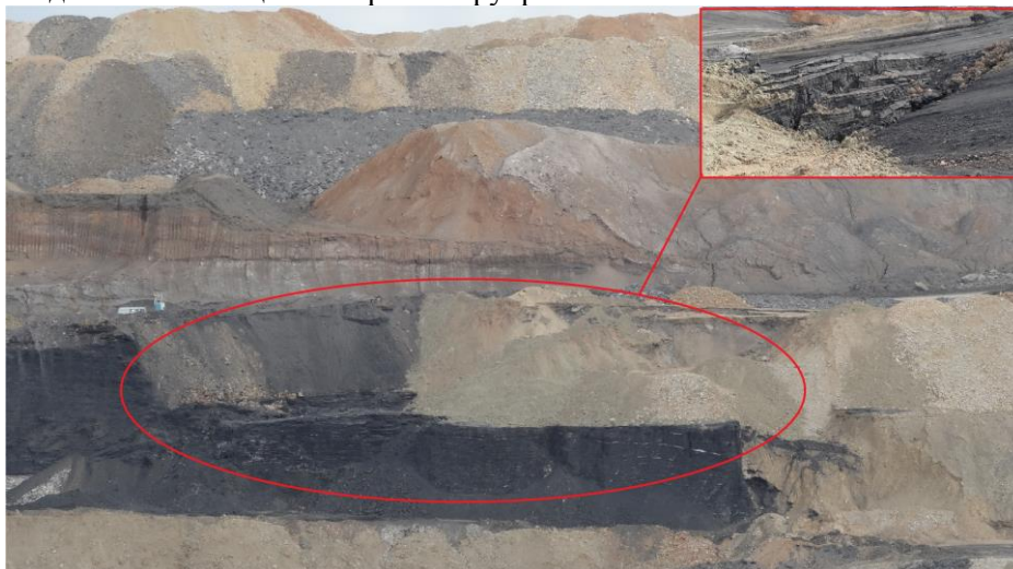
Рис. 2. Район деформаций на выходах пласта гор +450м.- +425м.
