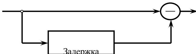
Рис. 1. Структурная схема однократной системы ЧПК
