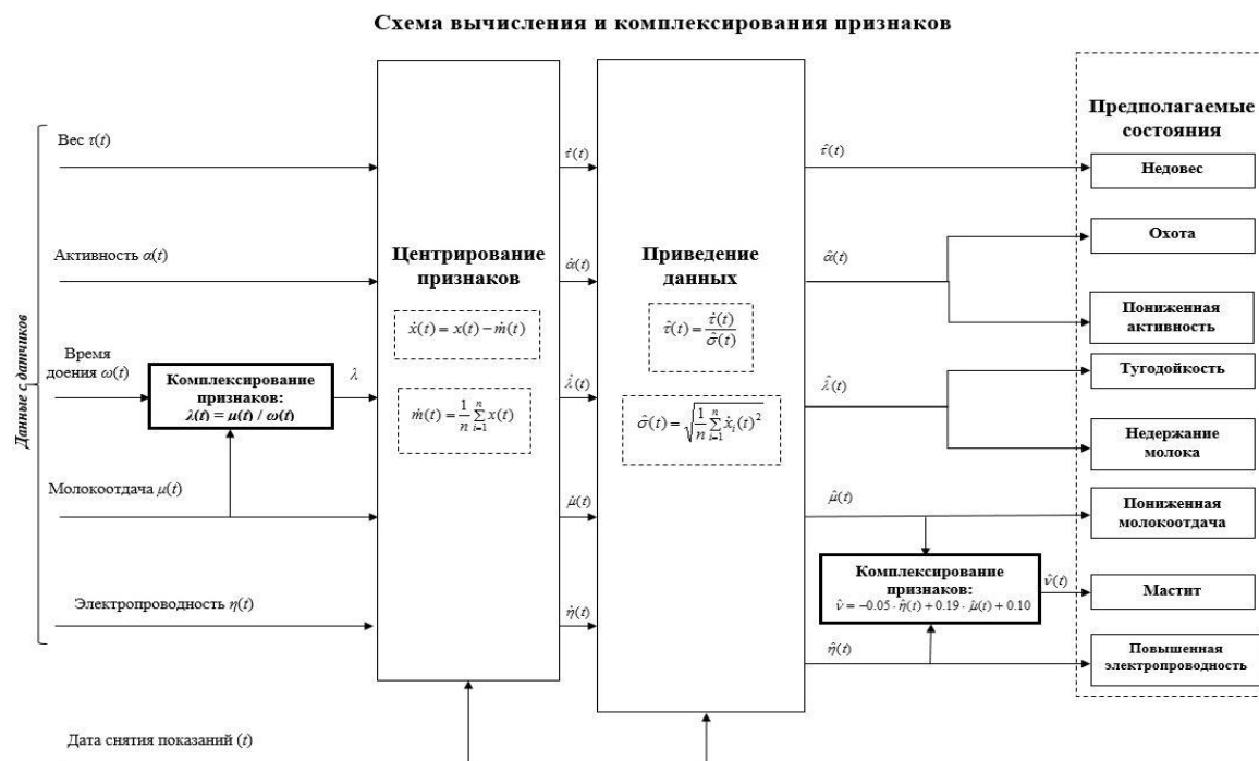
Рис. 1. Общая схема преобразования данных и выделения признаков для идентификации состояний животных молочного предприятия.
