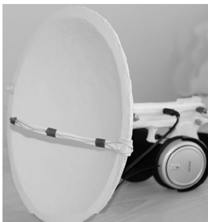
Рис. 4. Направленный микрофон с параболическим зеркалом диаметром 30 см
