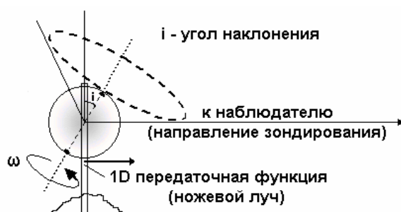
Рис. 2. Получение проекций при зондировании вращающегося объекта при фиксированном угле наклонения
