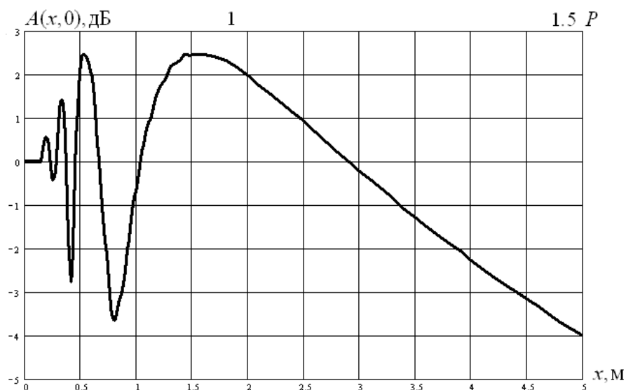
Рис. 1. Амплитуда ограниченного гауссова пучка в геометрооптической, френелевской и на начальном участке волновой зоны, \lambda = 7.5 \cdot 10^{-3} м
