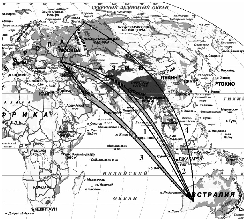
Рис. 4. Схема эксперимента и пути распространения сигналов: 1 – прямой сигнал; 2,3 – боковые сигналы с отражением от горного массива Гималаи и Иранского нагорья соответственно; 4 – аномальный сигнал с большой задержкой с рассеянием радиоволн от неоднородностей высокоширотной ионосферы северного полушария
